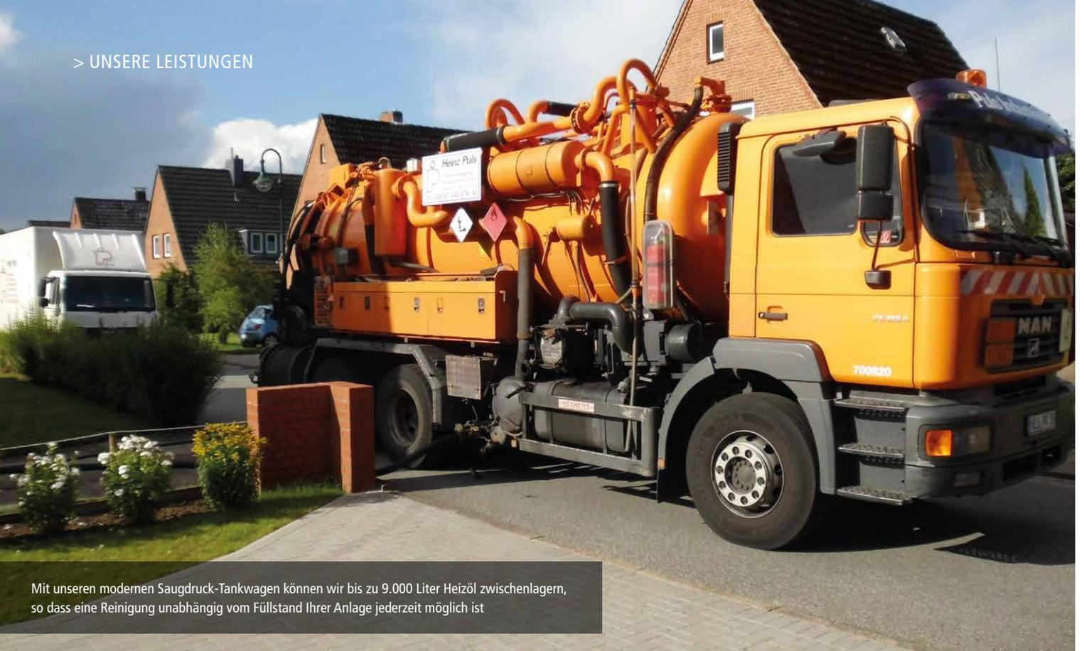
Mit unseren modernen Saugdruck-Tankwagen können wir bis zu 9.000 Liter Heizöl zwischenslagern, so dass eine Reinigung unabhängig vom Füllstand Ihrer Anlage jederzeit möglich ist
