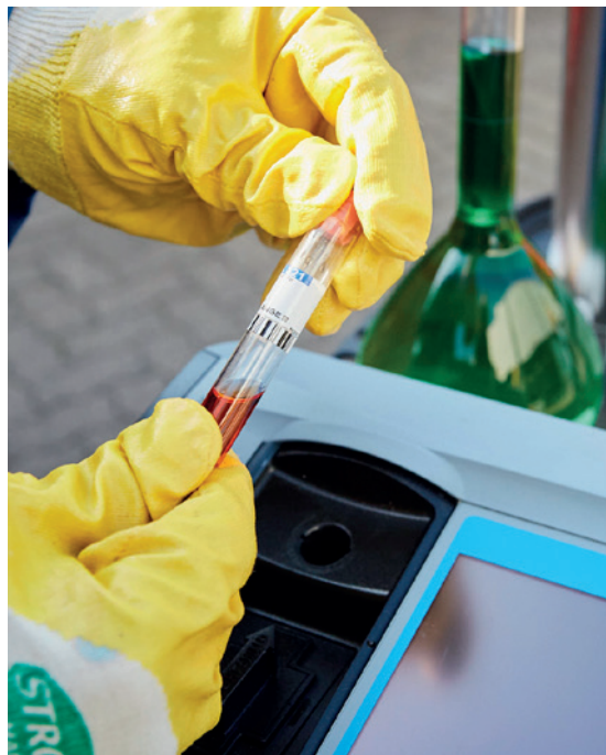
Während des Reinigungsprozesses werden regelmäßig Analysen durchgeführt. Im mobilen Labor prüfen wir pH-Werte, Säurekonzentrationen, Eisengehalt, Leitfähigkeit und Inhibitoren
